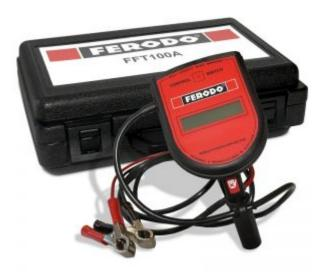
Il **Tester Ferodo** per il liquido freni verifica lo stato di salute del liquido freni, comunque e in ogni momento. Il Tester fornisce, in meno di un minuto, un'accurata lettura digitale della temperatura di ebollizione del liquido freni. Il Tester Ferodo, tramite un'apposita sonda, misura la temperatura di ebollizione in modo diretto; non misura la temperatura
