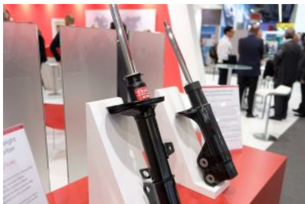
Prototipo di ammortizzatore leggero confrontato con un ammortizzatore standard
