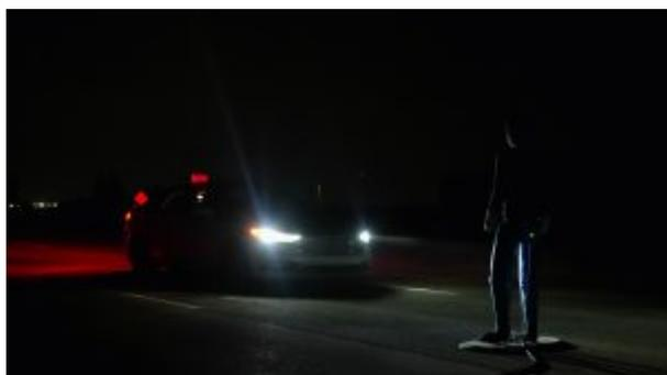
VSI Labs hanno verificato le prestazioni di un sistema PAEB a fusione di immagini termiche e visibili su un veicolo di ricerca Ford Fusion Hybrid e su tre sistemi commerciali PAEB di ultima generazione. La suite di sensori AEB a fusione termica comprendeva la più recente termocamera per autoveicoli a infrarossi a onde lunghe (LWIR) di Teledyne FLIR, un radar HD per autoveicoli e una telecamera nel campo del visibile per autoveicoli. Tutti e tre i
