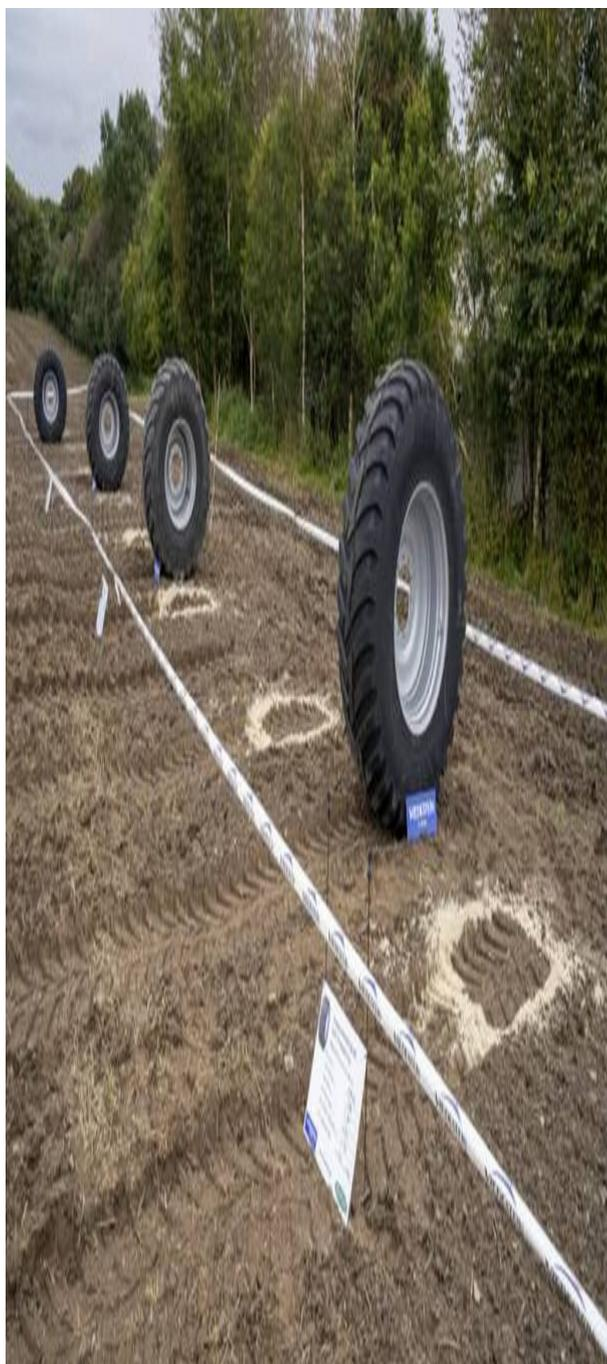
Con il pneumatico più grande è stato possibile ottenere un risparmio di carburante fino al 14% rispetto al pneumatico di riferimento.
