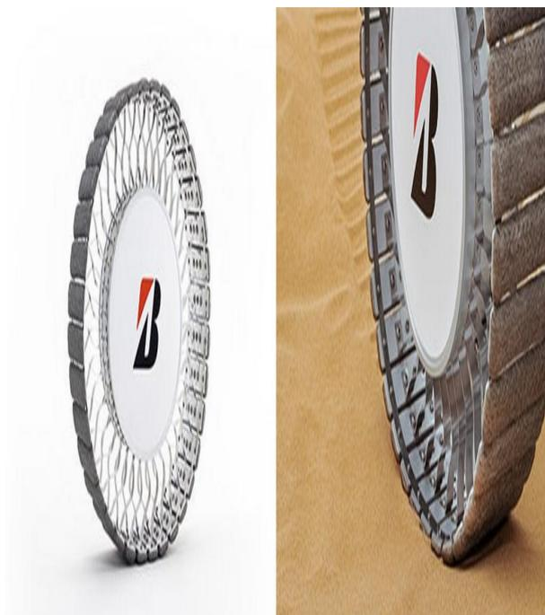
Il pneumatico Bridgestone per il rover lunare utilizza una struttura scheletrica di raggi metallici e presenta una struttura elastica che può deformarsi durante la guida su ostacoli, come le rocce lunari. Questo design mira a massimizzare l'assorbimento degli urti, la trazione e a migliorare l'efficienza energetica, fondamentale per le missioni estese.
