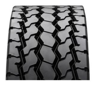
Il pneumatico DV-MM è caratterizzato da un design con scanalature ed intagli che, con una capacità superiore alla media, impediscono la ritenzione di sassi e altri oggetti, offrendo un miglior scorrimento dell'acqua e del fango, facilitando l'autopulizia del battistrada e preservando la carcassa del pneumatico.
