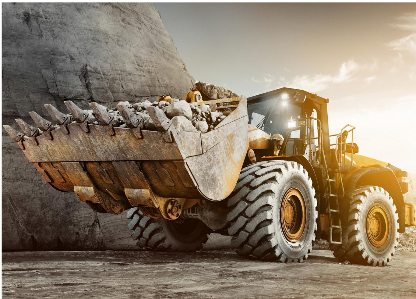
La carcassa rinforzata 3\* soddisfa i più elevati requisiti di capacità di carico, anche in caso di cicli produttivi estesi. Il disegno del battistrada L5 protegge la carcassa e garantisce un funzionamento regolare e sicuro nei cantieri. Il solido design dei blocchi del battistrada fornisce costantemente una trazione sicura. Il battistrada extra profondo e la protezione dei fianchi rendono inoltre il pneumatico più robusto, garantendo produttività a lungo termine.
