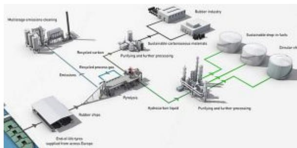
Per quanto riguarda il carbonio in forma solida invece, viene pulito e trasformato in rcb di recupero, che viene utilizzato nella realizzazione di prodotti in plastica e gomma.
