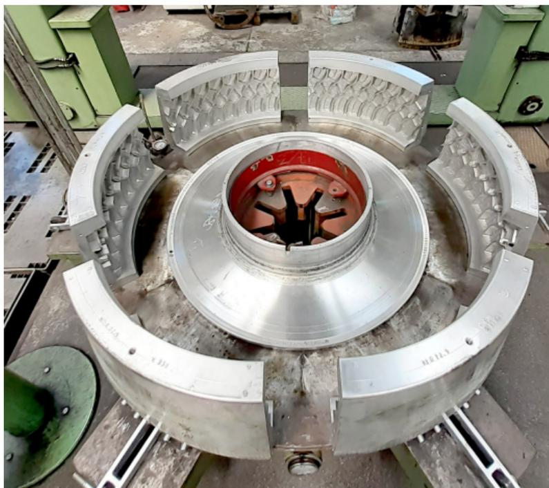
Il particolare battistrada è a blocchi trasversali con spalle aperte, un disegno che garantisce un'ottima trazione in tutte le condizioni, sia su strada che fuori strada, rendendo il pneumatico versatile e adattabile ai diversi fondi stradali. I blocchi del battistrada altamente trasversali garantiscono una trasmissione efficace delle forze di trazione. Inoltre, il disegno aperto e i blocchi interconnessi permettono una facile espulsione di fango e detriti,
