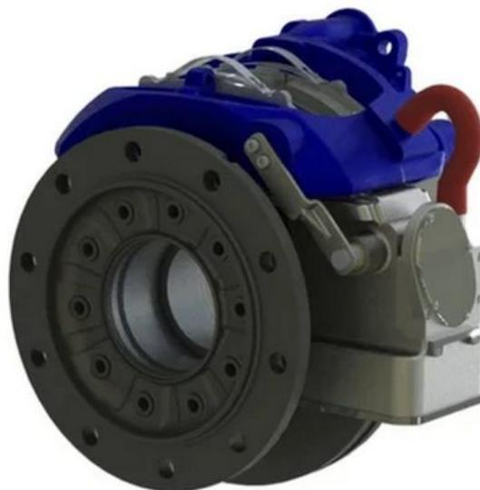
Raccolta e filtraggio delle particelle di polvere delle pastiglie rilasciate durante la frenata nei sistemi di freni a disco, meccanicamente, sia attivamente che passivamente, senza collegamento a nessun motore e parti elettroniche del veicolo, e prolungamento della durata del meccanismo della pinza del freno raffreddando le parti in elastomero con l'uscita della potenza di aspirazione ottenuta.
