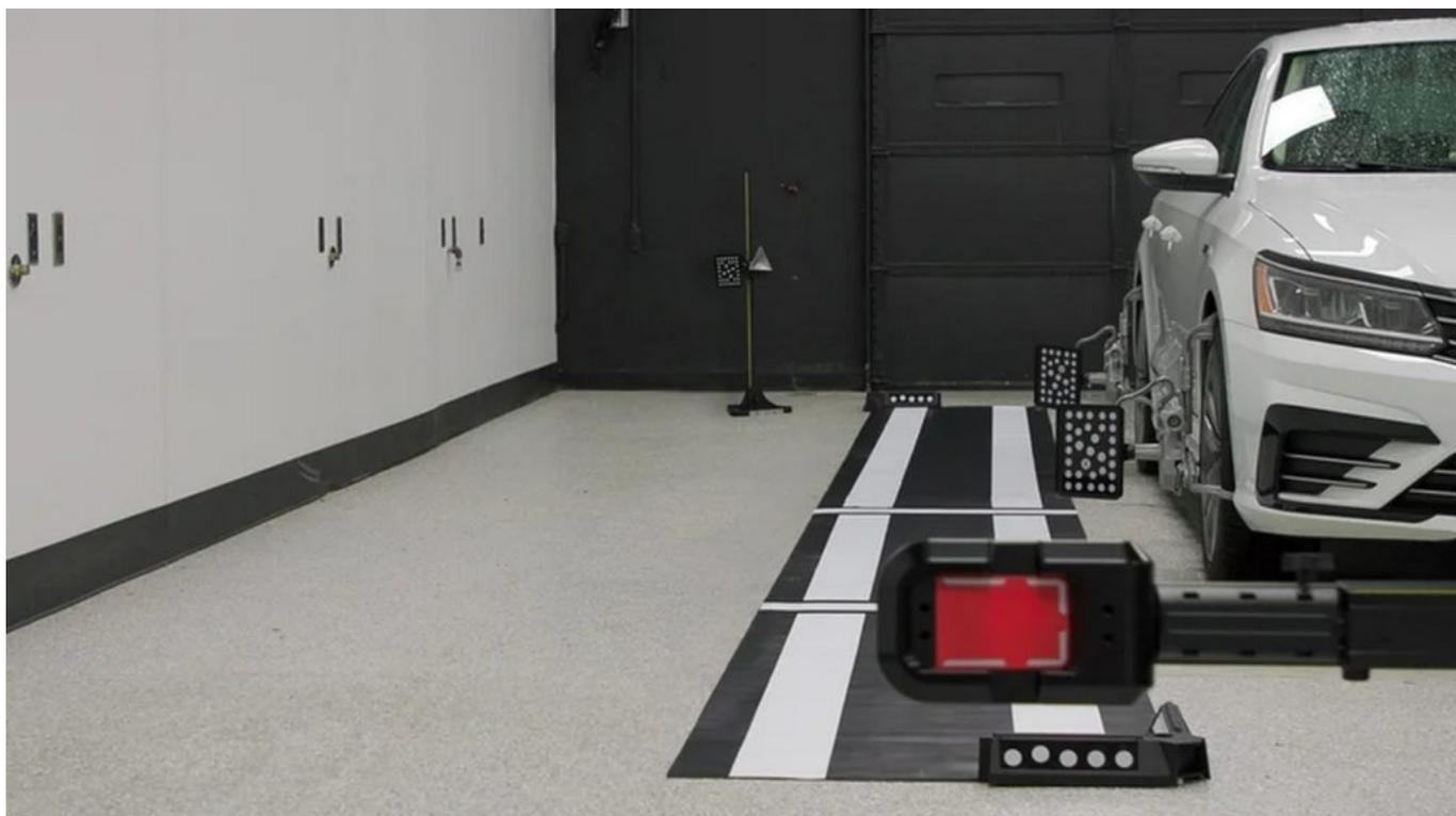
Utilizzando la tecnologia brevettata di misurazione della telecamera 3D, TGT-05 consente il posizionamento preciso di tappetini a 360° attorno al veicolo. BKT-16 utilizza le stesse telecamere per posizionare i dispositivi radar posteriori entro le tolleranze del produttore. I target vengono costantemente monitorati durante il processo di calibrazione degli ADAS per garantire che le riparazioni soddisfino le specifiche del produttore.
