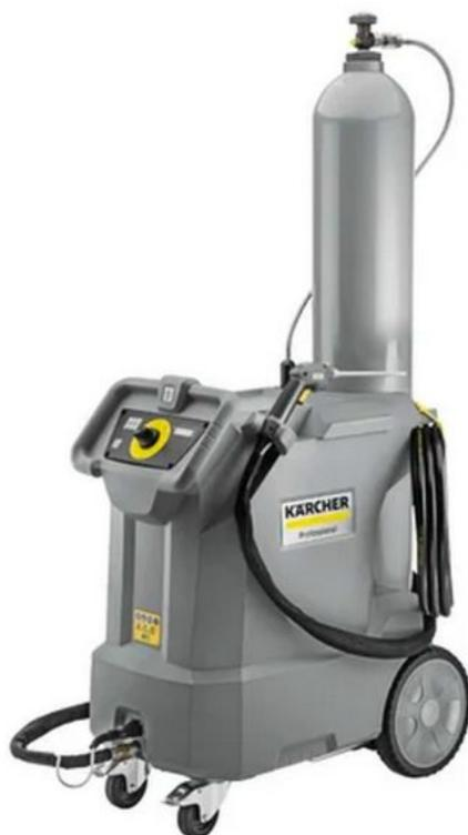
Il pulitore a ghiaccio secco IB 10/15 L2P Advanced fa parte del primo sistema di pulizia a ghiaccio secco al mondo con produzione di ghiaccio secco completamente integrata. Dalla bombola di gas CO2 direttamente ai pellet di ghiaccio secco, perfetto per applicazioni di pulizia spontanee senza una logistica costosa e complessa del ghiaccio secco. La pulizia efficiente senza acqua in aree sensibili non è mai stata così semplice.
