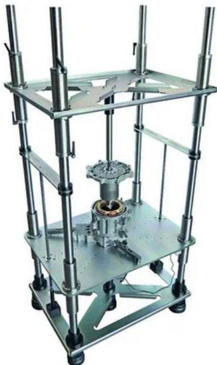
E-Drive Stator Lift è un dispositivo di separazione semiautomatico per lo smantellamento dei motori elettrici. Nonostante le forze magnetiche estreme, rotore e statore vengono separati senza danni. In alternativa ai motori di ricambio, è possibile installare pezzi di ricambio convenienti e reintrodurre i motori difettosi nel ciclo di utilizzo.
