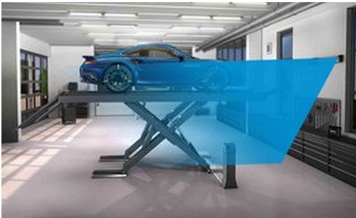
La precisione della misurazione dell'asse posteriore ha un'influenza diretta sui valori sull'asse anteriore. Con uno strumento come Q.Lign, ogni ruota ha una propria telecamera dedicata per ottenere la massima precisione per ogni veicolo. Altri sistemi a due telecamere disponibili in commercio, invece, devono catturare e misurare contemporaneamente sia l'asse posteriore che quello anteriore con una telecamera.
