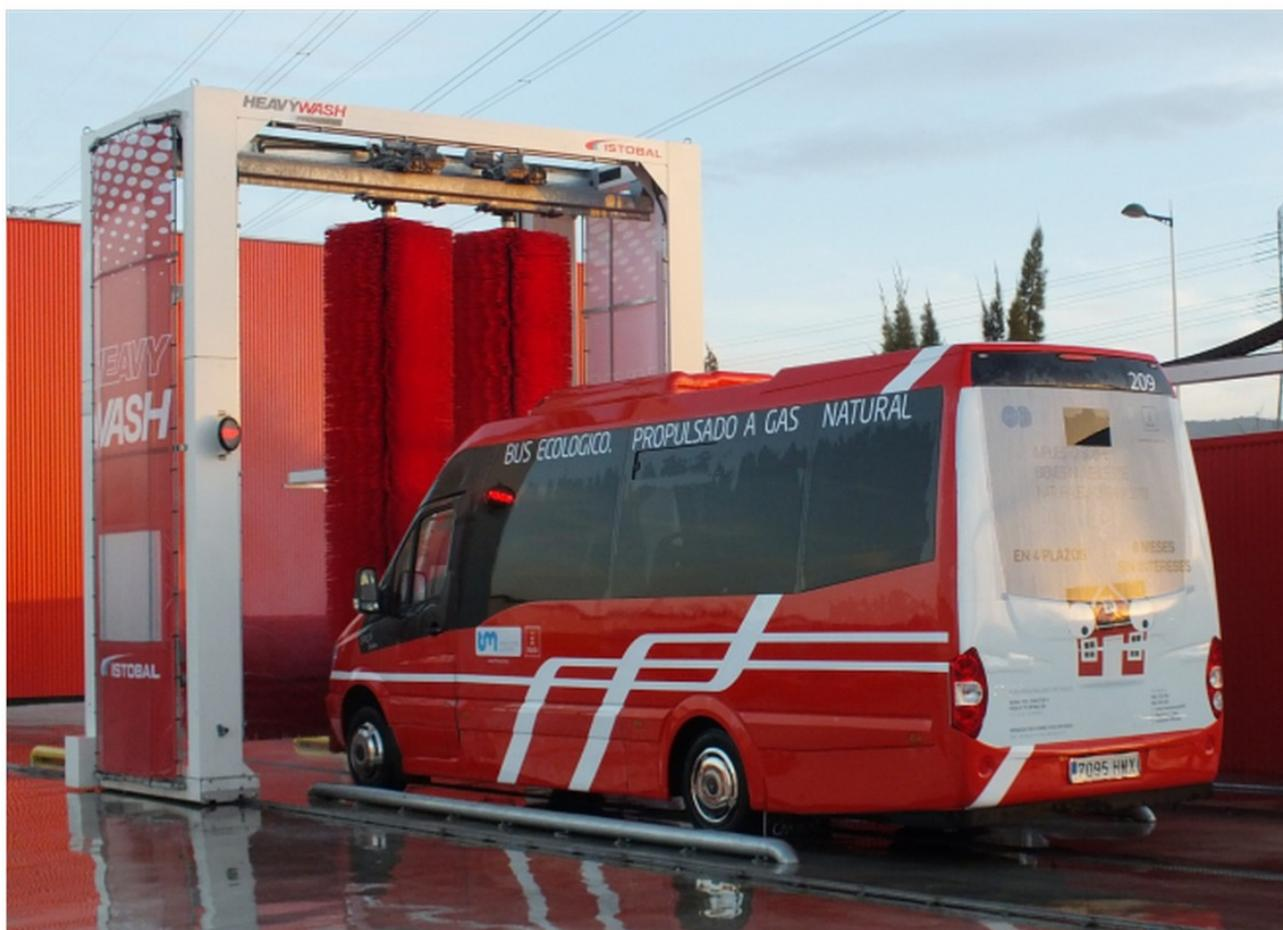
Una delle principali novità della nuova HW'PROGRESS2 è il suo sistema di spazzole migliorato, con diametri aumentati a 1100 mm. Il portale di lavaggio incorpora infatti diverse tecnologie che migliorano e rendono più sostenibile il processo di pulizia.
