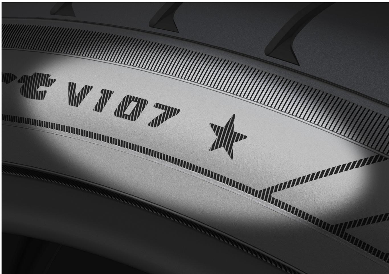
Le auto del BMW Group utilizzano pneumatici OE di un gruppo selezionato di produttori di pneumatici e il fianco di tutti gli pneumatici selezionati reca il simbolo di approvazione BMW, una **stella**, che indica il riconoscimento da parte della casa automobilistica tedesca delle capacità tecniche, della qualità e dell'affidabilità dei produttori di pneumatici.
