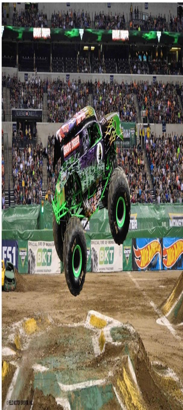
I Monster Jam truck attualmente montano pneumatici BKT con un'altezza di quasi 1,7 metri e un peso di 211 chilogrammi. Questi pneumatici vengono mantenuti a una pressione di gonfiaggio di circa 1.6 bar per garantire una serie di vantaggi, tra cui la capacità di assorbire gli shock dovuti ai salti e alle acrobazie e, non da ultimo, aumentare l'impronta a terra, migliorando quindi la trazione e riducendo lo slittamento.
