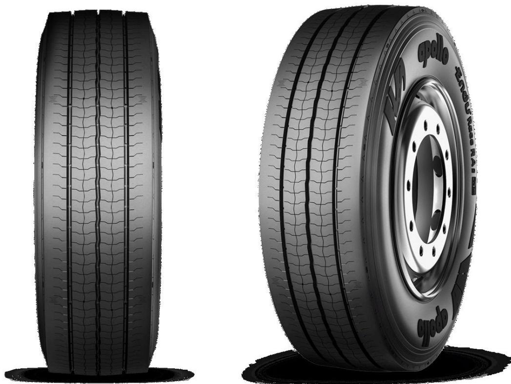
Rispetto al pneumatico per trasporto regionale EnduRace RA di prima generazione, l'EnduRace RA 2 vanta una riduzione del 10% della resistenza al rotolamento e una rumorosità media su strada inferiore a 1 dB, oltre a un miglioramento del 10% della trazione. Il nuovo pneumatico emette solo 72 dB di rumorosità stradale ed è classificato B per l'aderenza sul bagnato.
