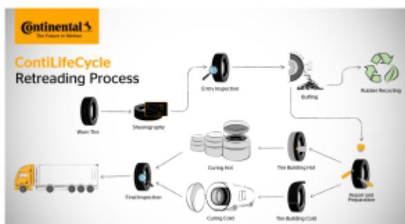
Lo stabilimento ContiLifeCycle di Stöcken combina un impianto di ricostruzione a caldo all'avanguardia per pneumatici per autobus e camion con il proprio impianto di riciclo della gomma su scala industriale. Oltre a ricostruire i pneumatici per autocarri e autobus, Continental ha sviluppato un processo di devulcanizzazione di composti di gomma vulcanizzata. La gomma riciclata risultante è di qualità particolarmente elevata, il che
