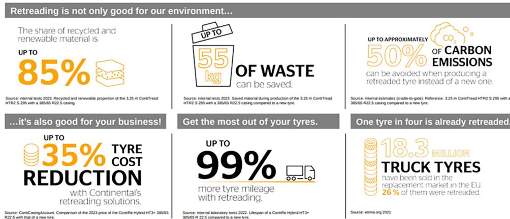
I ricostruiti rappresentano un mezzo efficace per ridurre l'impatto ambientale risparmiando materie prime, acqua ed energia durante la produzione. Anche se il battistrada è usurato, la carcassa è solitamente ancora perfettamente intatta. La ricostruzione prevede la rimozione della gomma rimanente del battistrada del pneumatico e il riutilizzo della carcassa per una seconda e persino una terza vita del pneumatico. Vengono utilizzati due diversi processi: ricostruzione a freddo e a caldo.
