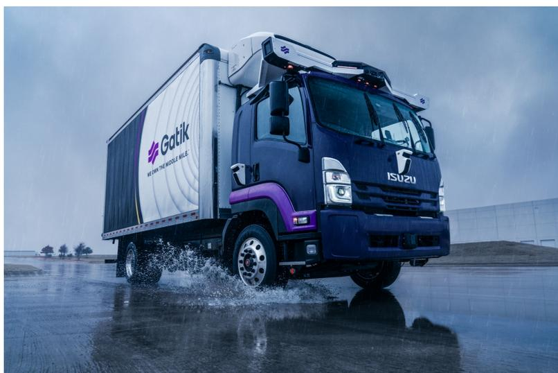
Attraverso test approfonditi su strada in un'ampia varietà di scenari di guida svolti su strade reali, i dati registrati dai pneumatici intelligenti relativi alle condizioni stradali e allo stato di usura del battistrada hanno aiutato Gatik a migliorare i suoi controller AV con approfondimenti sulla rigidità accurata in curva e in frenata, sulla resistenza al rotolamento e sul carico dei pneumatici.
