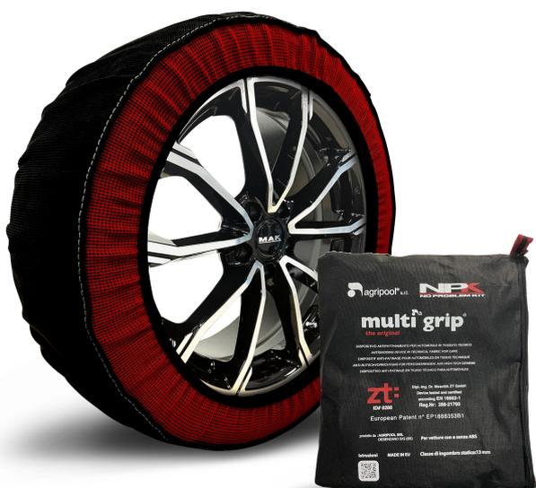
L'elevata qualità e spessore della fattura tessile risulta evidente al primo tocco. Il Plus della gamma The Original è la banda laterale colorata presente su entrambe le spalle dello pneumatico in grado di consentire l'auto-centratura del dispositivo in fase di montaggio: una caratteristica che la rende un prodotto su misura previsto appositamente in numerose taglie ed applicazioni.
