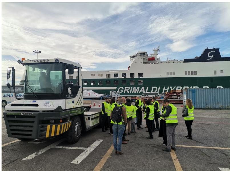
Si tratta di un prototipo di trattore portuale dotato di un propulsore ibrido a celle a combustibile e batteria che consente al veicolo di eseguire tutte le attività richieste durante le operazioni di carico/scarico delle merci dalle navi cargo.
