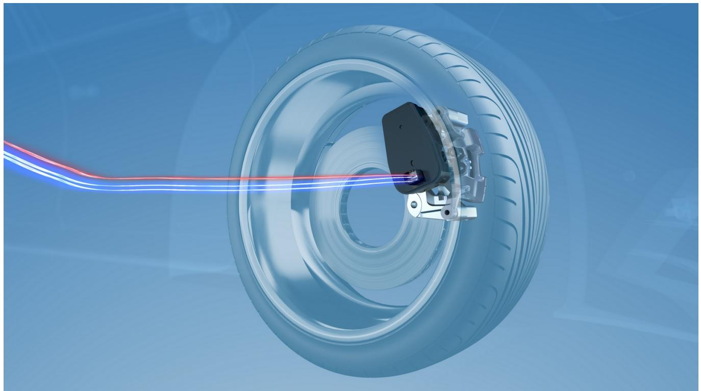
Caption: In the new, dry brake-by-wire system from ZF, the braking force on the wheel is generated by electric motors and no longer by a hydraulic system.//Die Bremskraft am Rad wird beim neuen, trockenen Brake-by-Wire-Bremssystem von ZF durch Elektromotoren erzeugt und nicht mehr durch ein Hydrauliksystem.
