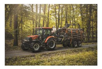
Si distingue per la robustezza data dalla mescola del battistrada, per la sua resistenza a tagli e lacerazioni, e per la struttura con cinture in acciaio che riduce significativamente il rischio di forature. Anch'esso garantisce ottima trazione e stabilità, anche su terreni
