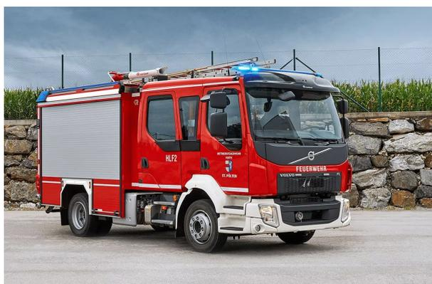
Il nuovo motore da 320 CV offre vantaggi anche per le attività di distribuzione regionale che potrebbero richiedere più potenza a causa della topografia impegnativa. Utilizzando il cambio automatico a 8 rapporti, progettato per una coppia di 1.200 Nm, è possibile impostare le modalità di guida incentrate sull'economia o sulle prestazioni, a seconda delle preferenze del conducente.
