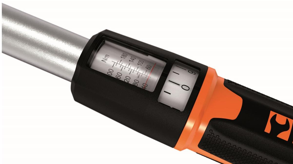
Il cuore dell'innovazione della Zero-Reset si trova nella tecnologia che ha eliminato la necessità di scarico a fine utilizzo. Altri elementi distintivi sono la precisione di serraggio  $\pm 3\%$ , superiore quindi alle indicazioni della norma UNI EN ISO 6789, il cricchetto reversibile per serraggi destrorsi e lo scatto meccanico percepibile all'udito e al tatto, che segnala il
