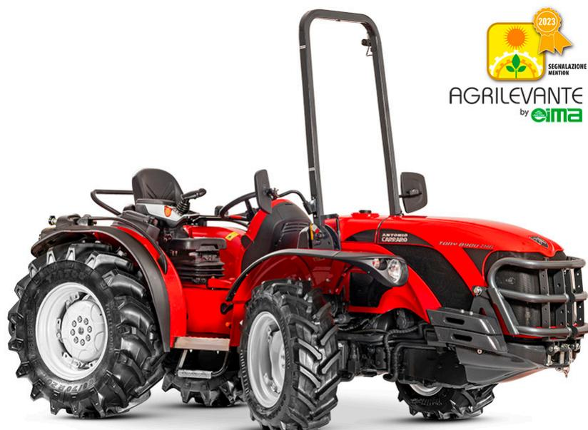
Il Tony 8900 TRG basso è un trattore specializzato, sterzante, reversibile con ruote differenziate con trasmissione idrostatica, specializzato per la coltivazione di agrumeti, oliveti e frutteti, oltre che a lavorare in vigneti in condizioni di forte pendenza. Questo trattore ha ruote differenziate, per un'ottima trazione e aderenza al terreno anche in condizioni di pendenza estrema e avendo le ruote anteriori più piccole è possibile effettuare una sterzata molto precisa.
