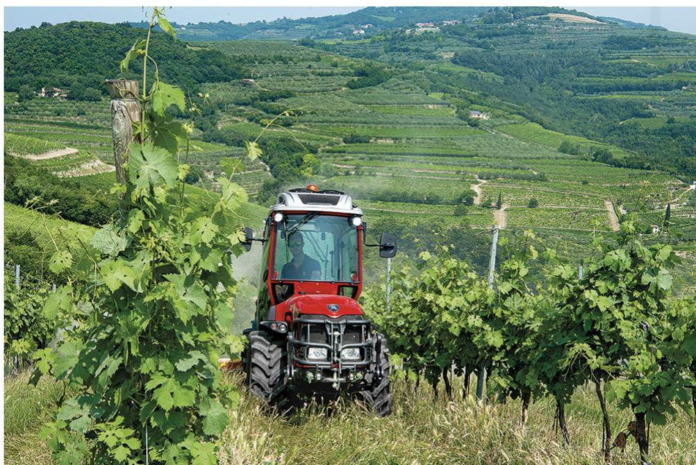
Il modello SN 6800 V è l'isodiametrico monodirezionale a telaio articolato più stretto di tutta la Serie Tora. Un trattore specializzato dal design scattante e compatto, i parafanghi avvolgenti, le fiancate a filo e il posto di guida ribassato: elementi fondamentali per un agile disimpegno tra la vegetazione e tra i filari più stretti e bassi. Grazie al telaio articolato e al passo corto, questo modello offre un ridotto raggio di sterzo.
