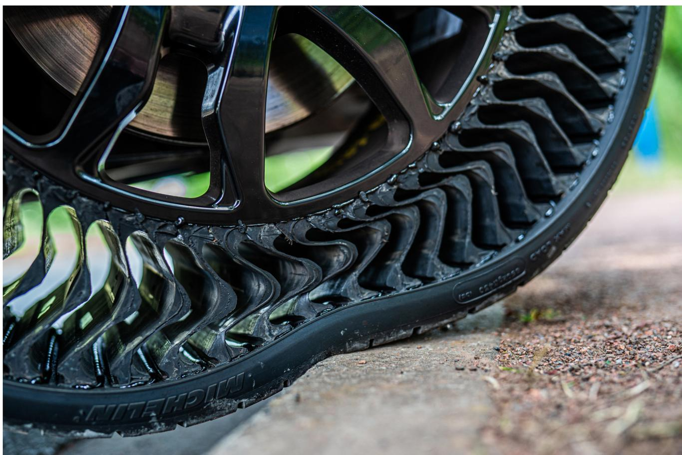
Le gomme **Uptis** (Unique Puncture-proof Tire System), [presentate da Michelin nel 2019](#), hanno una struttura lamellare in resina termoplastica e gomma, che assicura sostegno e ammortizzazione. Le gomme, che vengono montate su ruote ad hoc realizzate da Maxion Wheels, non sono soggette a forature e quindi riducono i tempi di fermo macchina e i costi di manutenzione.
