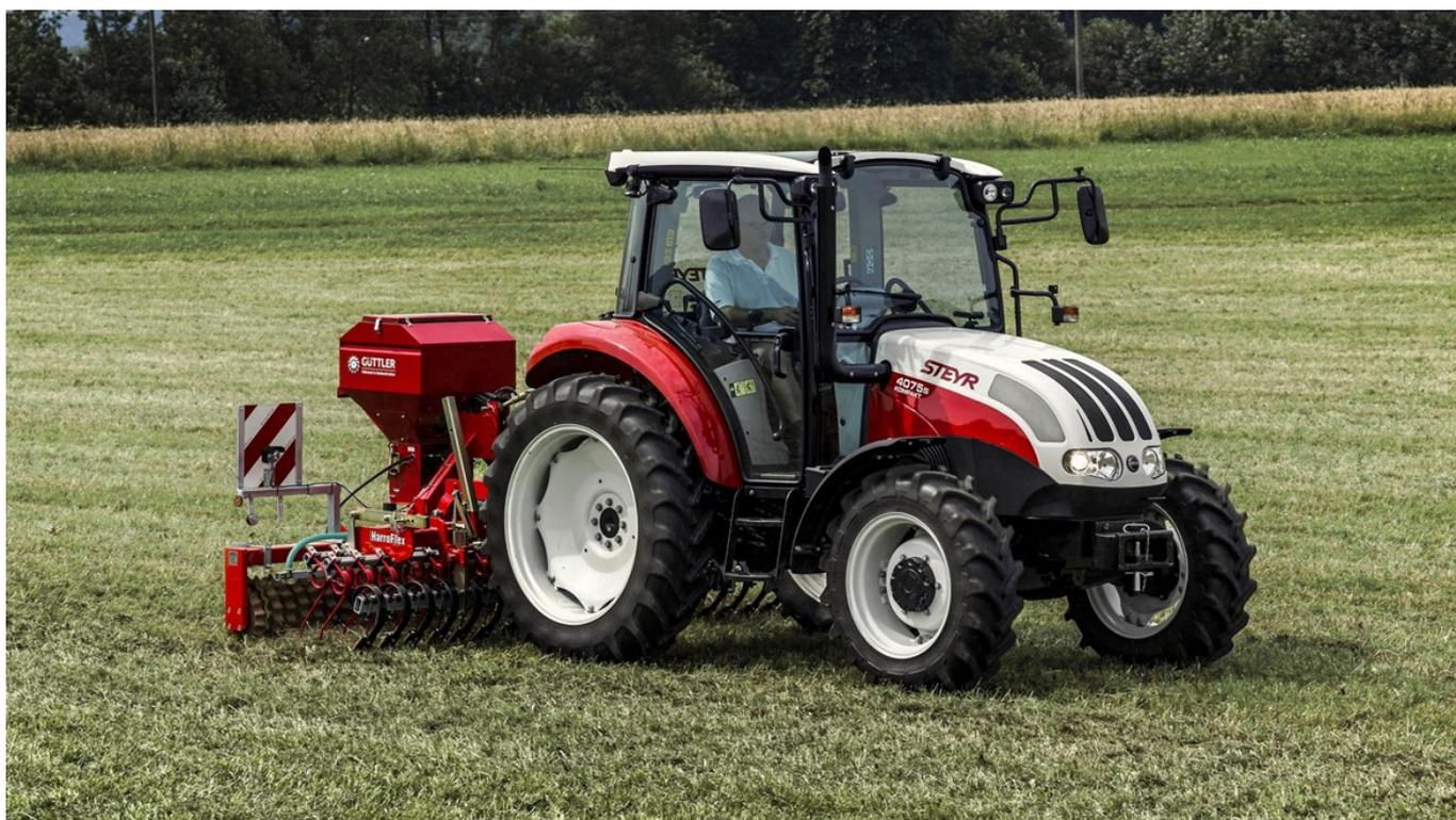
Alimentato, come gli altri trattori Kompakt S, da un motore FPT F5C da 3,4 litri turbocompresso e intercooler con intervalli di manutenzione di 600 ore, anche il 4075 Kompakt S presenta la stessa trasmissione 12AV/12RM con velocità massima di 30 o 40 km/h ed è disponibile nelle varianti 2wd o 4wd.
