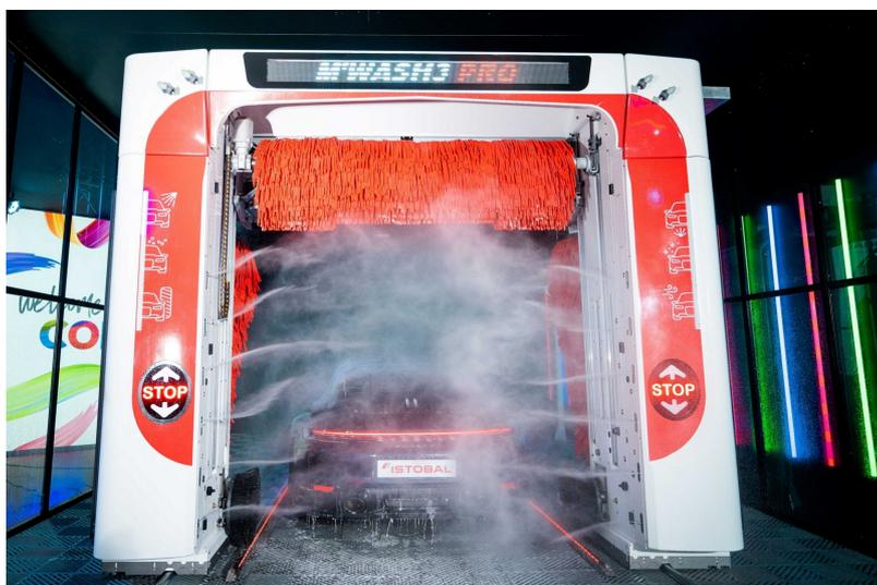
L'autolavaggio a portale M'WASH3 di ISTOBAL ha un'inclinazione verticale delle spazzole in due direzioni (laterale e posteriore) per garantire la migliore qualità di lavaggio in qualsiasi tipo di auto.
