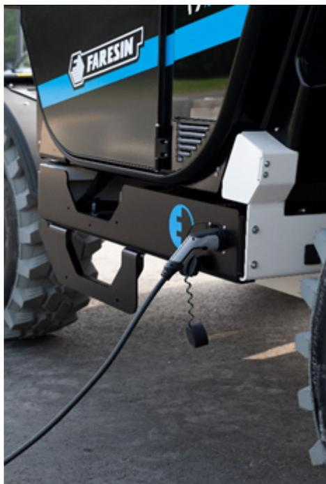
Inoltre grazie a un sistema chiamato **Universal Charge**, d'ispirazione automobilistica, è possibile ricaricare le batterie con assoluta flessibilità, grazie ad un'unica interfaccia plug in per le alimentazioni 220V monofase e 400V trifase come per le stazioni di ricarica rapida pubbliche e private. Un sistema che supera definitivamente il problema della disponibilità asimmetrica di diversi sistemi di alimentazione nei mezzi da cantiere elettrificati.
