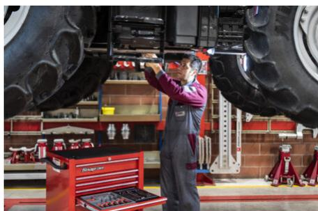
Le colonne mobili idrauliche senza cavi rappresentano la massima espressione della tecnologia nel sollevamento, completamente wireless, sono sincronizzate con un dispositivo a radio frequenza ed alimentate a batteria ricaricabile. Per il funzionamento delle colonne di sollevamento, Stertil-Koni offre l'ebright Smart Control System: facili da caricare tramite una presa a parete da 230 V. Sono disponibili nella versione ST 1075 con portata 7.500 kg e ST 1085 con portata 8.500 kg.
