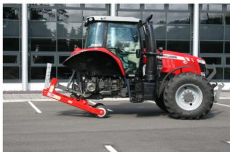
Ideale in operazioni quali lo smontaggio delle ruote per la sostituzione degli pneumatici, il lavaggio accurato dietro i passaruota oppure lavorare sulle fiancate. Il sistema consente di mettere in completa sicurezza il veicolo dopo il sollevamento grazie ai piedini di stazionamento regolabili in altezza. Il sistema può essere montato anche sul sollevatore anteriore così da sollevare completamente il veicolo e rendere agevoli tutte le operazioni a livello ruote o mozzi ruota.
