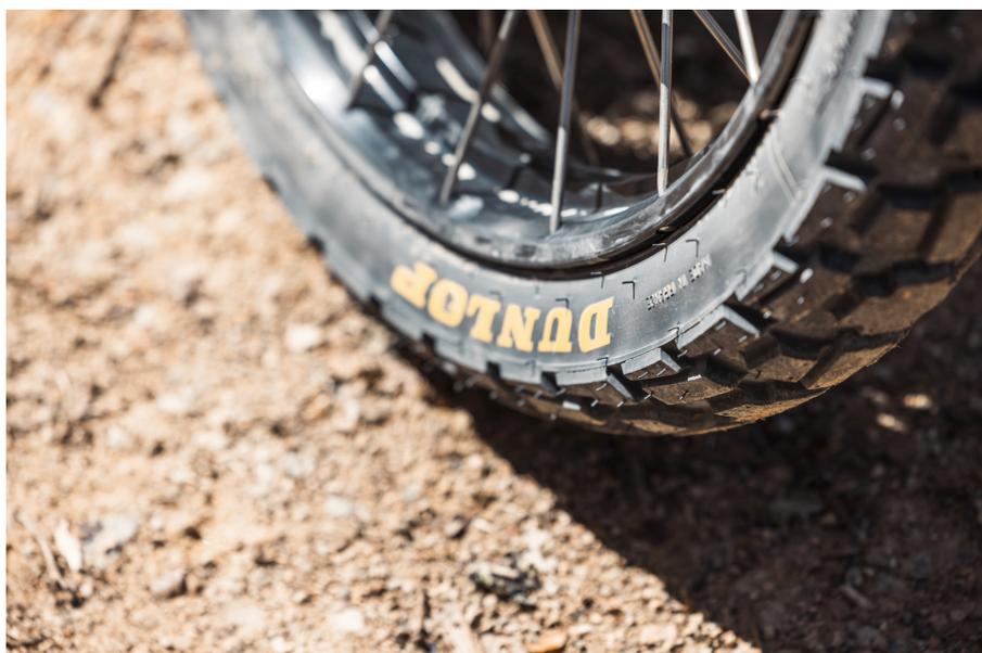
Il design di Trailmax Raid è stato ispirato dal D908 RR di Dunlop, un pneumatico da rally raid prettamente fuoristrada, caratterizzato da tasselli pronunciati, che ora sono una parte fondamentale del profilo di Trailmax Raid.
