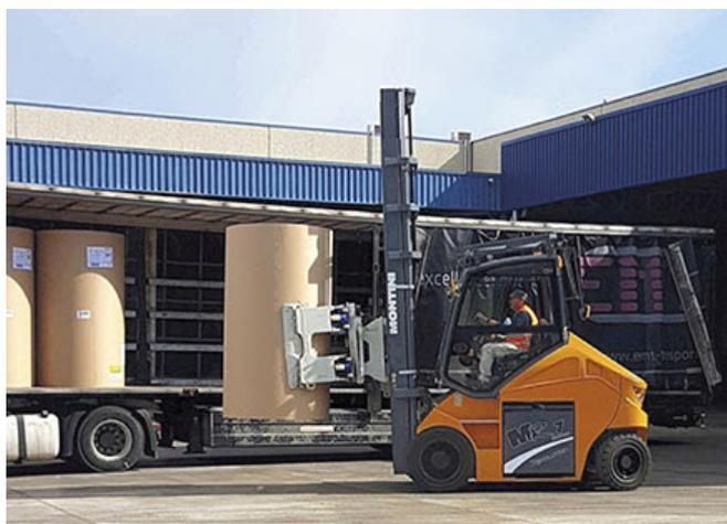
I carrelli elevatori elettrici di grande portata Montini destinati a lavori gravosi, con capacità di carico da 6 a 18 tonnellate a baricentro da 600 a 900 mm, sono adatti a molteplici soluzioni logistiche personalizzabili e sono stati sviluppati, principalmente, per un uso flessibile in vari settori.
