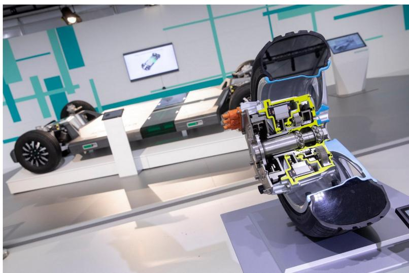
La caratteristica distintiva dei nuovi motori per i mozzi delle ruote è che tutti i componenti necessari per l'azionamento e la frenata sono integrati direttamente nel cerchione, anziché essere posizionati centralmente o montati sugli assali motore.
