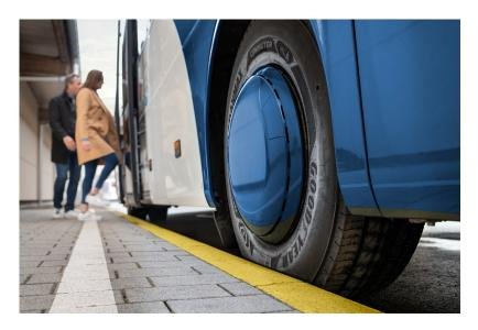
Il pneumatico presenta anche scanalature "IntelliMax" per ridurre l'usura del battistrada e migliorare la trazione e la stabilità. Le lamelle "Flexomatic" e i tasselli interconnessi del battistrada migliorano la trazione in frenata. Le lamelle 3D si incastrano e limitano il movimento del blocco per un elevato chilometraggio e un'eccellente trazione invernale. È anche certificato 3PMSF (3-Peak Mountain Snowflake) per l'uso invernale, mantenendo le persone in movimento tutto l'anno.
