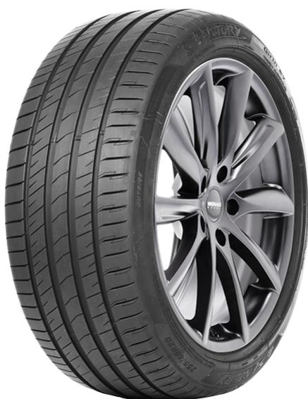
La parte centrale del battistrada è formata da un blocco ad alta rigidità. Ciò non solo garantisce che questo pneumatico soddisfi gli elevati requisiti di usura dei pneumatici EV, ma offre al conducente ancora più vantaggi:
