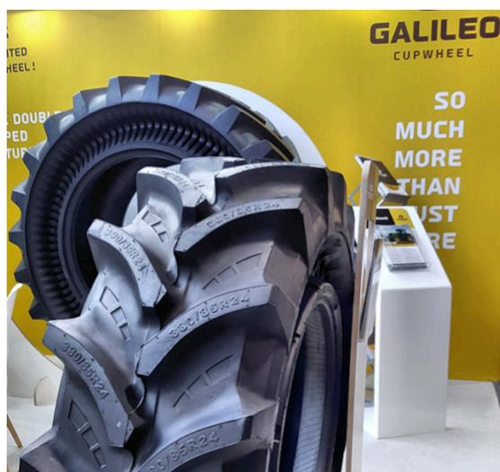
La tecnologia CupWheel combina i vantaggi dei pneumatici radiali fuoristrada e dei cingoli in gomma su un cerchio standard, abbassando i costi e la manutenzione e aumentando la resa e la facilità d'uso per le aziende agricole ed edili. La durata del battistrada è estesa e la funzione autopulente ottimizza l'aderenza e la produttività. Il mezzo può anche essere guidato a zero bar di pressione (capacità runflat integrata), consentendo di viaggiare anche in caso di foratura.
