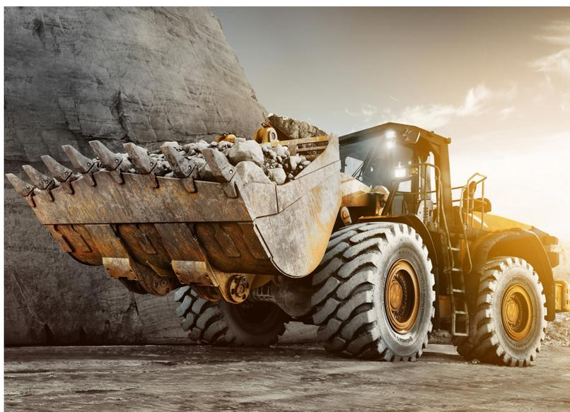
Secondo Continental, la carcassa rinforzata 3\* soddisfa i più elevati requisiti di capacità di carico, anche in cicli di produzione estesi. Il disegno del battistrada a trazione L5 protegge la carcassa e garantisce un'operatività regolare e sicura, mentre il design solido del tassello del battistrada offre grande trazione.
