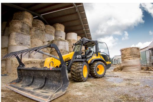
Possiamo definire il Pivot come una pala gommata con braccio telescopico. A differenza dei telescopici fissi con assali sterzanti e telaio rigido, si contraddistingue per un'articolazione centrale che unisce il telaio anteriore a quello posteriore. La macchina è quindi in grado di sterzare tramite l'articolazione a doppio snodo centrale, che favorisce così maggior controllo e manovrabilità del mezzo.
