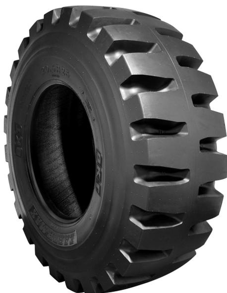
E poi ancora **EARTHMAX SR 53**, con le nuove varianti della misura 29.5 R 29, ora disponibile sia in classe L-5 \*\* UMS (Underground Mining Service) che L-5 \*\*\* super resistente. La profondità del battistrada di classe L-5 riduce fortemente l'usura dello pneumatico, oltre a mostrare eccellenti proprietà autopulenti. La sua miscela speciale offre
