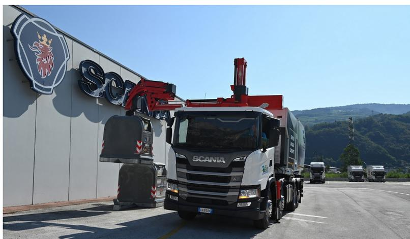
A livello operativo, il nuovo mezzo entra in funzione immediatamente dopo lo svuotamento dell'umido, effettuato da un altro veicolo. L'acqua sporca, recuperata in due serbatoi, al rientro del veicolo in sede viene poi processata nel depuratore di ASIA per essere riutilizzata.
