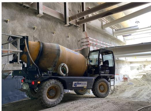
All'interno del cantiere di Berna, le **autobetoniere** si occupano di **alimentare gli spruzzatori che rivestono le pareti della galleria**. Quella appartenente alla gamma DIECI è l'autobetoniera idrostatica **italiana che raggiunge maggiore potenza, producendo 100 m3 di calcestruzzo in sole 5 ore di lavoro**.
