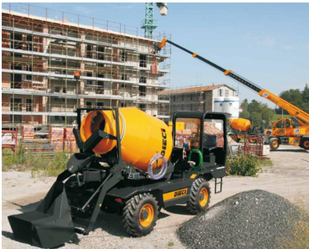
In questi casi il mezzo migliore è sicuramente un'autobetoniera auto-caricante, un automezzo compatto dotato di una pala per caricare gli inerti nel proprio bicchiere e di un serbatoio d'acqua.
