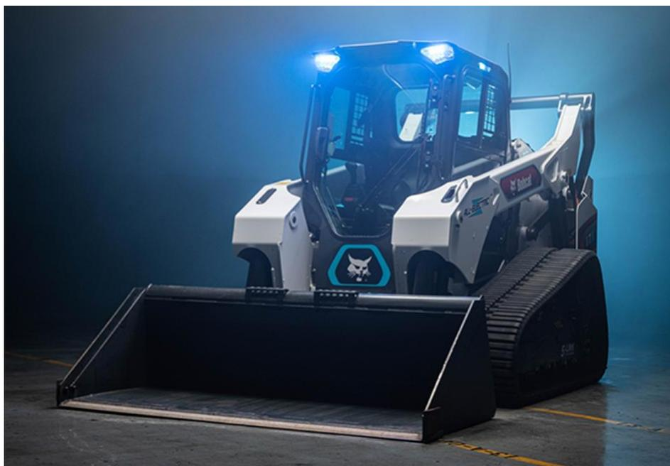
La Bobcat T7X è la prima pala compatta cingolata 100% elettrica al mondo. Questa macchina è alimentata completamente a batteria ed è stata progettata da zero per essere più produttiva grazie all'azionamento e alla propulsione elettrica, più silenziosa con una coppia ad alte prestazioni e più potente di qualsiasi altra pala cingolata diesel, il tutto eliminando qualsiasi emissione di carbonio.
