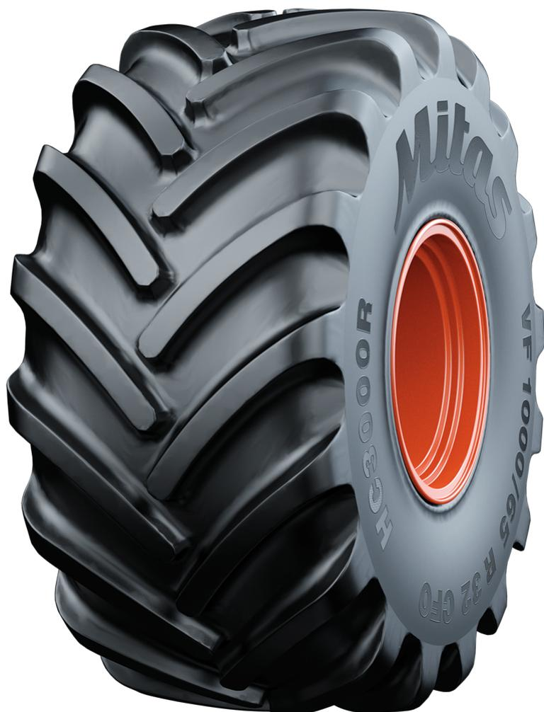
A differenza di altri pneumatici della gamma Mitas HC utilizzati principalmente sulle mietitrebbie, il nuovo pneumatico HC 3000 R è stato progettato per carribotte spargiliquame. *“Abbiamo sviluppato questo nuovo pneumatico per far fronte alla domanda del mercato di un pneumatico ad alta capacità di carico per carribotte, con un nuovo disegno battistrada nel pieno rispetto del terreno”* spiega **Pavel Kott**, Product Manager dei pneumatici agricoli Mitas.
