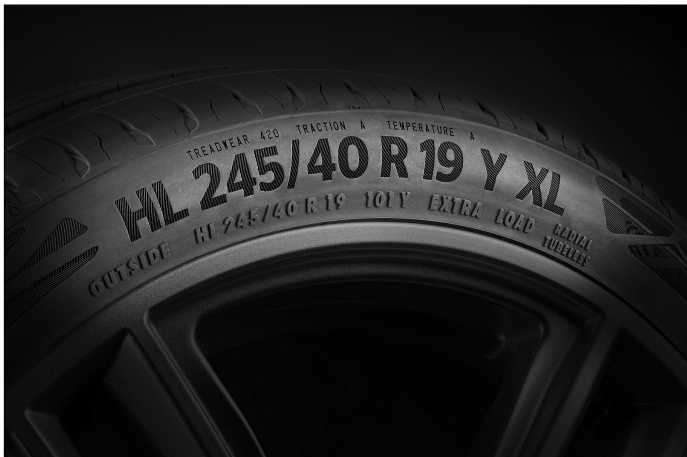
Sul fianco, i prodotti con la nuova capacità di carico mostrano il codice HL prima della dimensione, come ad esempio "HL 245/40 R 19 101 Y XL". La capacità di carico di questo pneumatico HL è di 825 kg (indice di carico 101), che equivale a un aumento del 10% rispetto allo standard XL di 750 kg (indice di carico 98).
