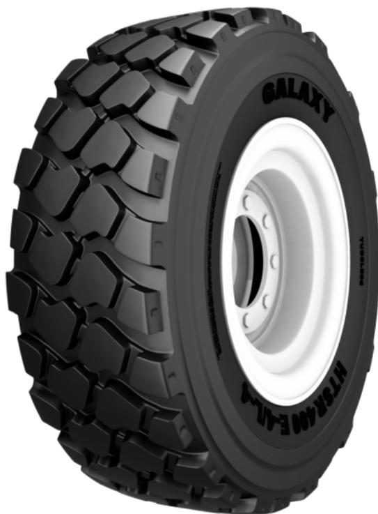
I clienti che utilizzano i dumper articolati (E-4) nel settore minerario possono scegliere uno pneumatico HTSR 400 con mescola resistente alle alte temperature. Questo tipo di mescola è stata appositamente progettata per percorsi lunghi ad elevate velocità, in modo da evitare il surriscaldamento degli pneumatici durante le operazioni di trasporto di carichi pesanti sulle lunghe distanze e lunghe ore di esercizio.
