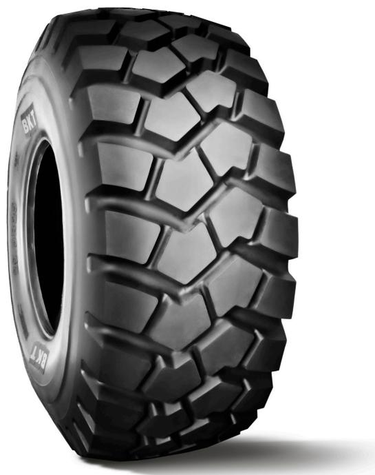
La struttura *All Steel* che caratterizza tutti gli pneumatici di questa gamma rende i diversi modelli Earthmax particolarmente adatti alle attività nei grandi cantieri, nelle cave e nelle miniere, resistendo a forature, penetrazione di corpi estranei e altri danneggiamenti della carcassa.
