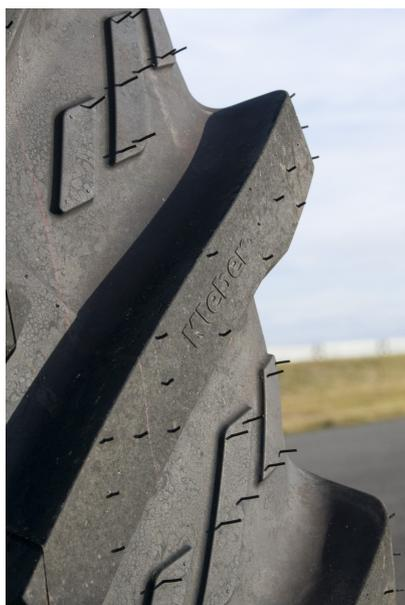
Kleber Topker IF, offre - alla stessa pressione di gonfiaggio, rispetto a un pneumatico standard (come il Kleber Topker) - una capacità di carico maggiore del 20%; oppure, a parità di carico la possibilità di impiegare pressioni inferiori del 20% rispetto ai pneumatici standard delle stesse dimensioni.
