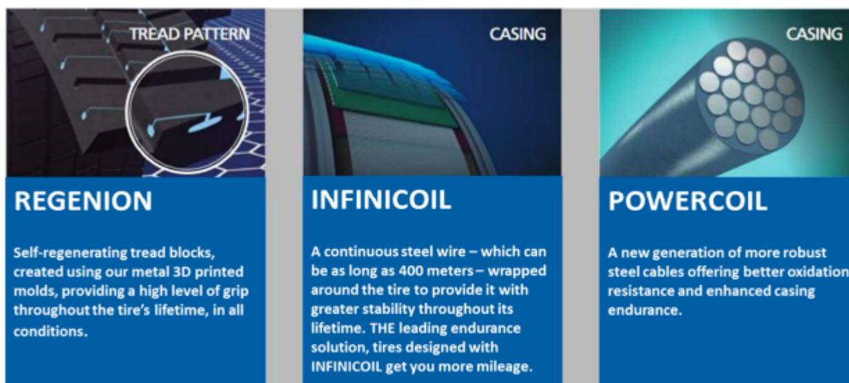
La tecnologia **Michelin Infinicoil** consiste in un filo di acciaio lungo fino a 400 metri avvolto continuamente intorno alla corona, per migliorare la stabilità del battistrada, risparmiare carburante e allungare la vita del pneumatico, aumentando così il chilometraggio.
