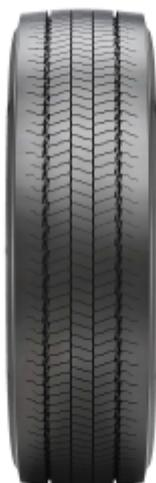
MC:01 e-Urban presenta una **resistenza al rotolamento ribassata del 10%** rispetto al predecessore e si classifica **best in class con classe di efficienza energetica B**. MC:01TM e-URBAN contribuisce così ad **incrementare l'autonomia di degli autobus urbani, a ridurre i cicli di ricarica** della batteria per veicoli completamente elettrici, e al **contenimento delle emissioni di CO<sub>2</sub>**.
